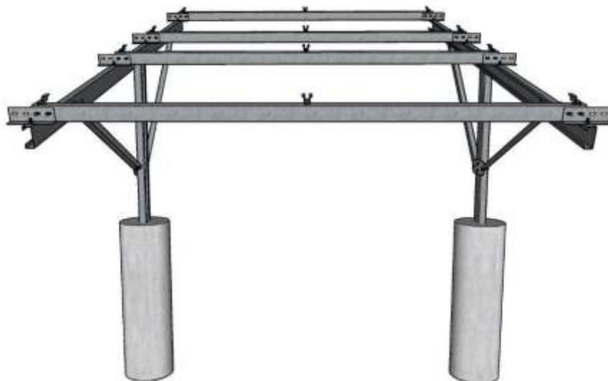
OBS.: Vãos entre pilares variam conforme layout dos módulos, solicite seu projeto de montagem.
